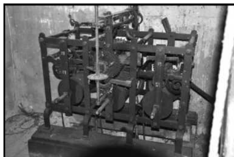
Mecanismul ceasornicului din turn – 2014
