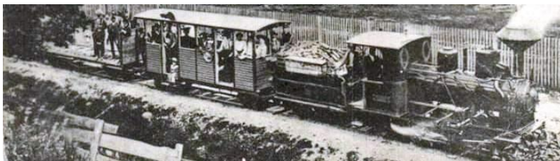
Foto 51. Tren cu vagon de transport persoane în componență, tractat de o locomotivă JUNG
