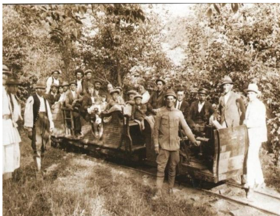
Foto 56.Vagonet (drezină) pentru transport persoane utilizat în diverse ocazii, pentru deplasarea la domeniul forestier al familiei Mocioni, vagonetele erau tractate de cai
